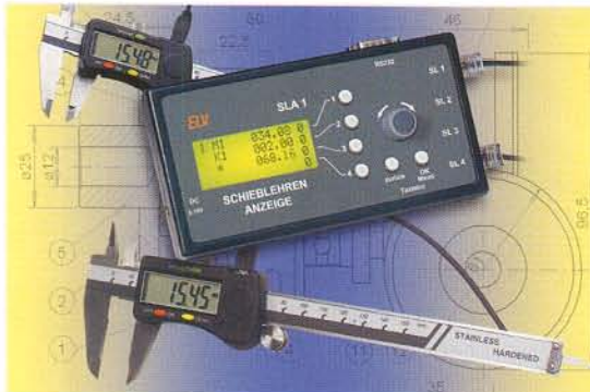
▲ Schieblehrenanzeige SLA 1 Zeigt die Werte von bis zu vier digitalen Schieblehren an und ermöglicht Berechnungen. Mit PS/2-Tastaturport zur Dateneingabe und seriellem Port zur Datenweitergabe Seite 12
