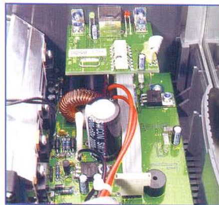
Bild 63: Anschluss des USB-Moduls an die Basisplatine
