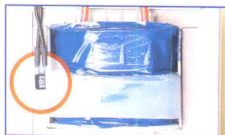
Bild 56: Befestigung des Temperatursensors am Netztrafo
