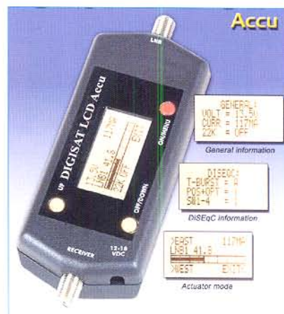
Bild 20: Ein erstaunlicher Funktionsumfang für knapp 70 €: Spannung, Strom, DiSEqC-Kommandogenerator und -leser, Ansteuerung von Rotoren, Summenpegel und manches mehr. Quelle: http://www.emitor.se/websites/emitorse/egnafiler/shop/admbilder/pdf/Digisat%20Lcd%20accu%20A4.pdf
