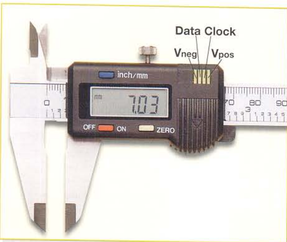
Bild 3: Typische Anschluss- belegung einer Schieb- lehre
