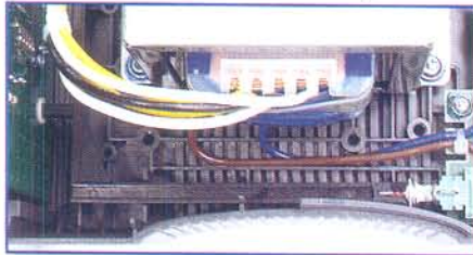
Bild 60: Verlegung der primärseitigen Trafoanschlussleitungen
